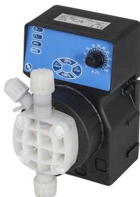
Bombas dosadoras eletromagnéticas de regulagem manual, por meio de potenciômetro no painel. Possui dupla escala (0-100% e 0-20%) de regulagem da vazão, ideal para dosagens mais precisas. Possui luzes indicadoras de força, pulso e escala selecionada. Painel em filme de policarbonato resistente a produtos químicos. Gabinete em plástico reforçado. Grau de proteção IP 65. Disponível em versões para montagem em parede (DLX) ou base (DLXB).
