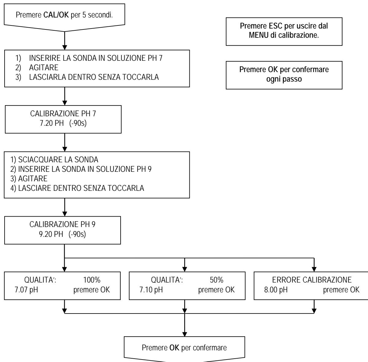
**NOTA:** Una volta calibrato l'elettrodo con la soluzione pH 9 lo strumento potrebbe mostrare l'allarme di errore concentrazione, questo allarme scomparirà quando l'elettrodo stesso sarà messo in esercizio.
