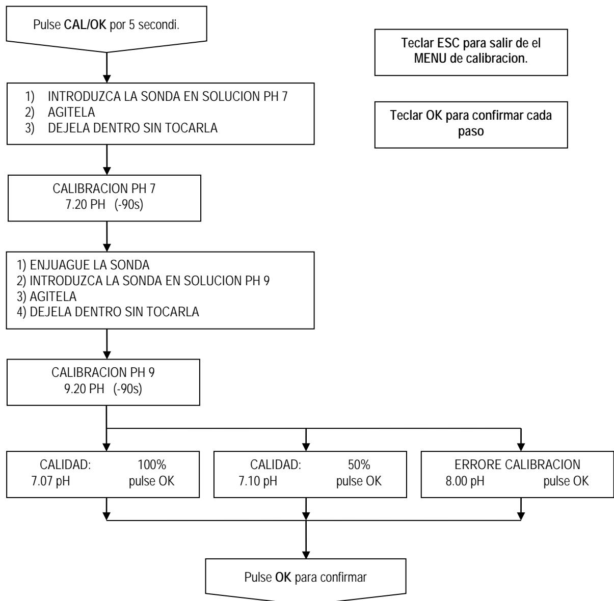
NOTA: Despues de calibrar el electrodo con el pH de la solucion 9 del instrumento podría mostrar el error de concentración de alarma, esta alarma desaparecerá cuando el electrodo se pone en funcionamiento.
