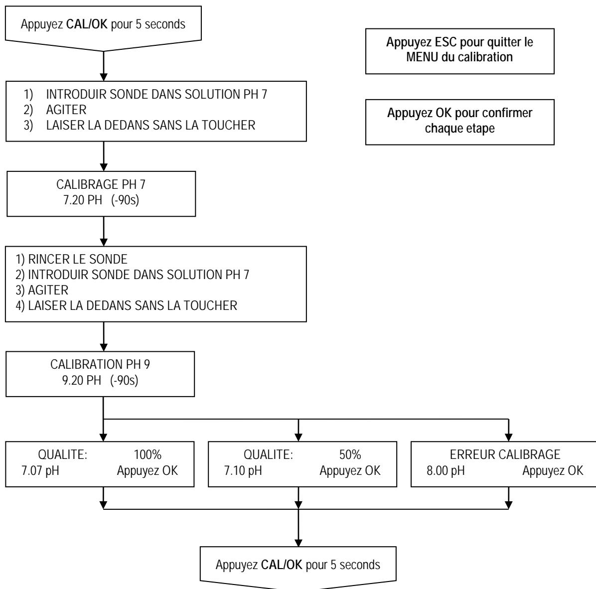
NOTE: Après le calibrage de l'électrode avec la solution pH 9 l'instrument pourrait montrer l'erreur de concentration d'alarme, cette alarme disparaît lorsque l'électrode est mise en service.
