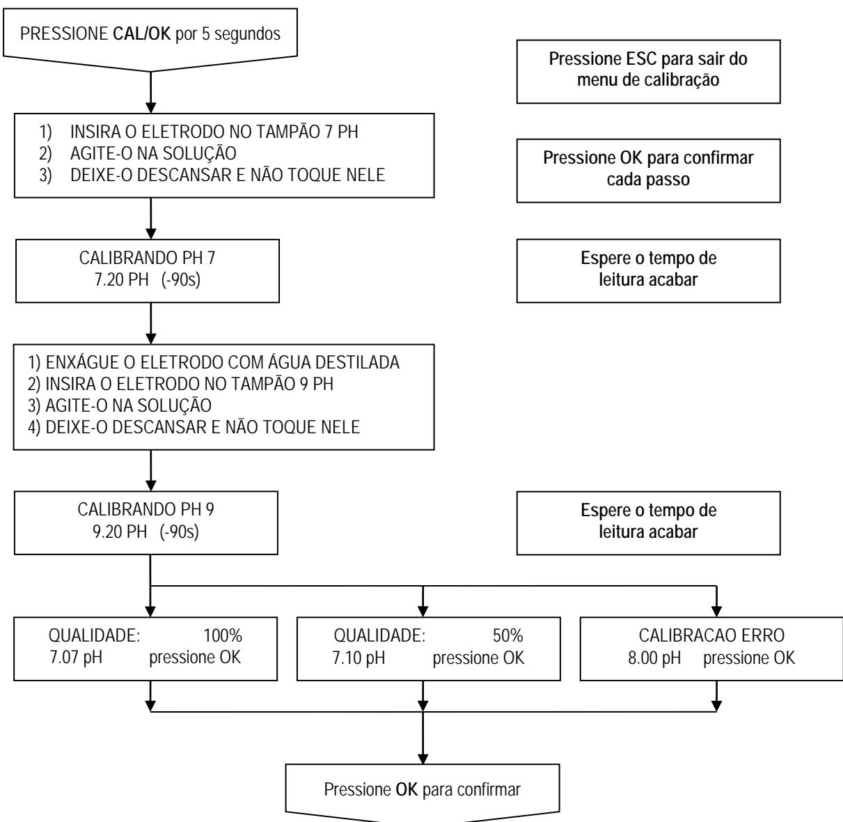
**NOTA:** Após a calibração, o eletrodo na solução 9 pH fará o instrumento mostrar o alarme de erro de concentração; este alarme desaparecerá quando o eletrodo for colocado em operação.
