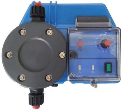
Bombas dosadoras eletromagnéticas de **regulagem manual**, ideal para as mais precisas dosagens. Possui luzes indicadoras de força, pulso e nível baixo. Painel em filme de policarbonato resistente a produtos químicos. Gabinete em alumínio protegido com pintura epóxi anti-ácido. Grau de proteção IP 65 com a tampa do painel fechada.
