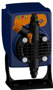
Bombas dosadoras eletromagnéticas compactas, com regulagem de vazão de 0-100% **por meio de sinal de corrente 4-20 mA**. Painel em filme de policarbonato resistente a produtos químicos. Gabinete em plástico reforçado, possui suporte de fixação que permite a instalação em parede ou em base. Grau de proteção IP 65. É predisposta para uso com sensor de nível tipo bóia que para a bomba dosadora em caso de falta de produto no reservatório.
