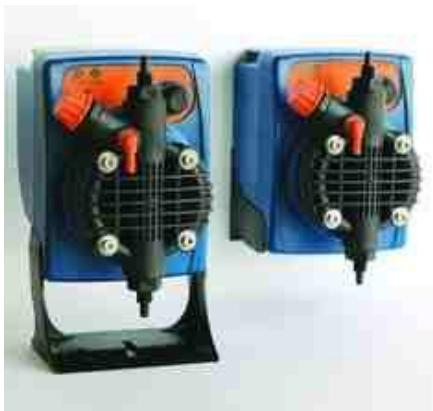
Bombas dosadoras eletromagnéticas compactas, com regulagem de vazão de 0-100% por meio de botão analógico. Painel em filme de policarbonato resistente a produtos químicos. Gabinete em plástico reforçado, possui suporte de fixação que permite a instalação em parede ou em base. Grau de proteção IP 65.
